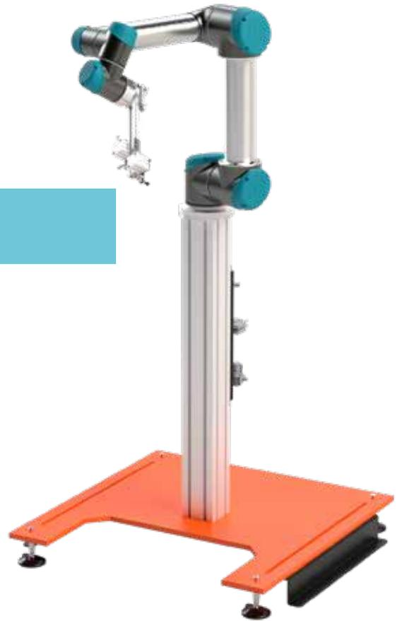
Um robô de machine tending é um **sistema automatizado projetado para operar máquinas industriais**, como tornos CNC, centros de usinagem ou prensas, realizando tarefas de carregamento e descarregamento de peças de forma precisa e eficiente.
